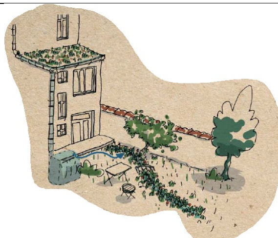
Toiture verte extensive, connectée à une citerne avec trop plein vers une noue (maison unifamiliale)
